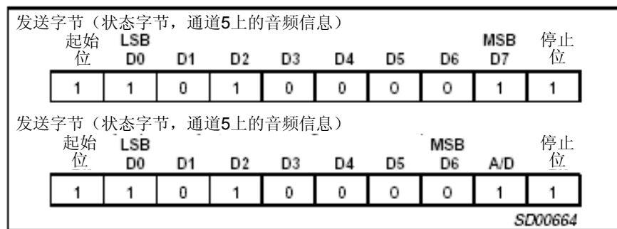
图4. MIDI主机生成的给通道5的状态字节
